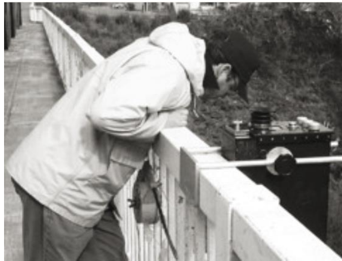
Σχήμα: Στροβοσκοπική οπτική μέθοδος (WMO, 2010)
