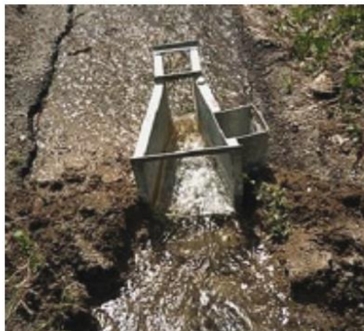
Σχήμα: Μέτρηση χαμηλών παροχών με κατασκευή σύγκλισης ροής (WMO, 2010)
