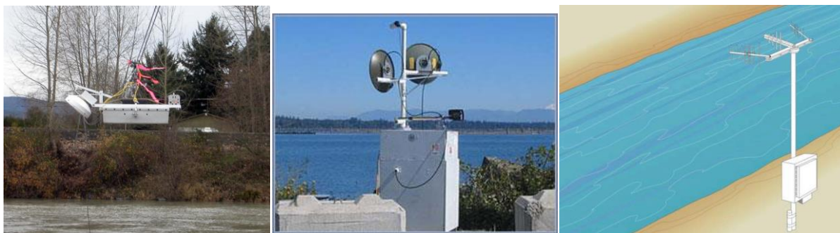
Σχήμα: Αριστερά RiverScat (Costa et al., 2006) και GPR αναρτημένα από καλώδιο, κέντρο RiverRad (AIRS, 2018), δεξιά RiverSonde (RiverSonde, 2008)
