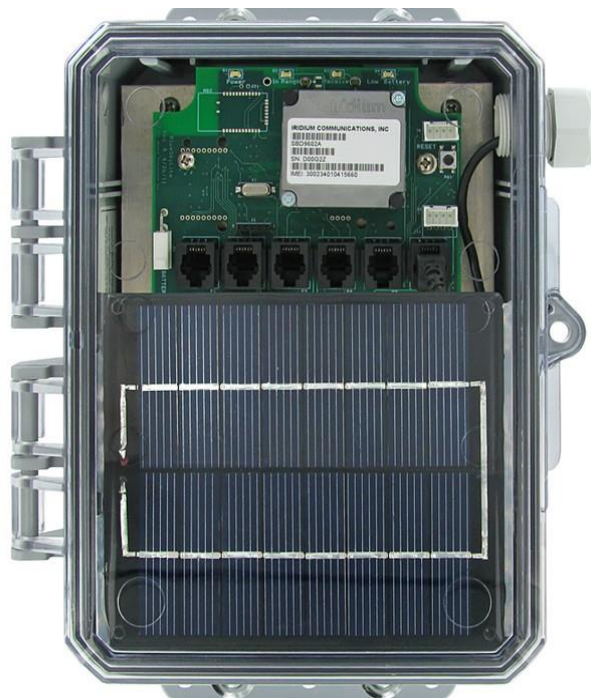
Σχήμα: Δορυφορικός πομποδέκτης DataGarrison Satellite (DataGarrison, 2018)
