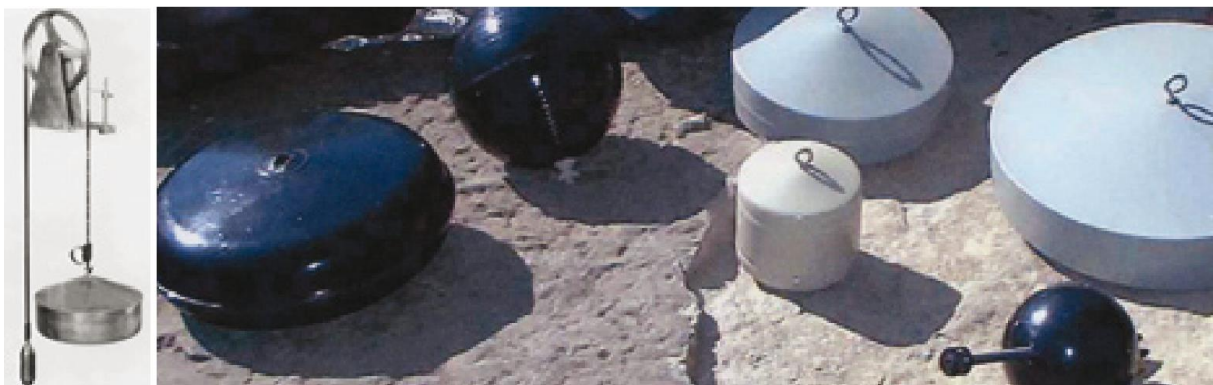
Σχήμα: Μέτρηση στάθμης με χρήση πλωτήρων (WMO, 2010)
