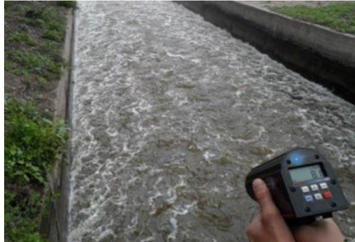
Σχήμα: Ραντάρ SVR χειρός (Tamari et al., 2013).
