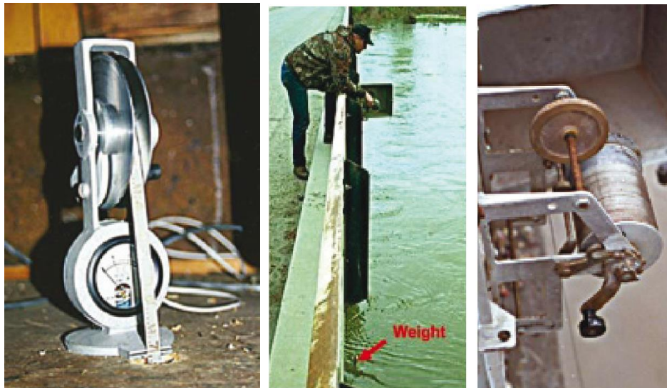
Σχήμα: Μέτρηση στάθμης με χρήση ταινίας (WMO, 2010)
